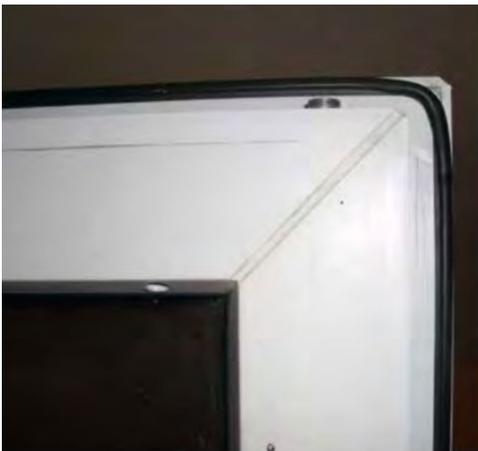
Ventana de PVC con inglete sin soldar.
