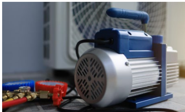
Bomba de vacío
