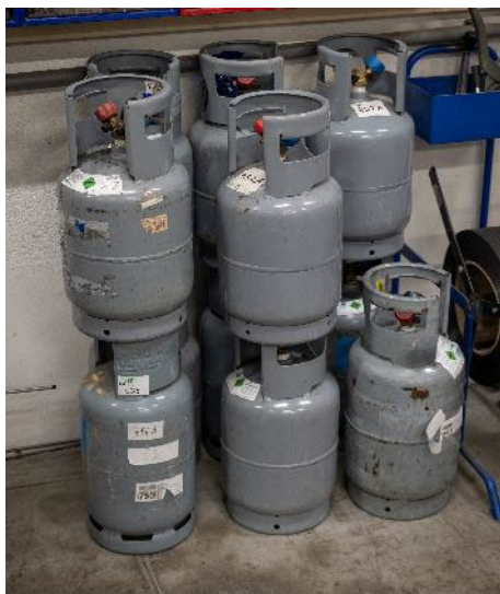
Error: botellas apiladas unas sobre otras
